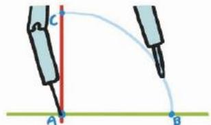
Tomamos la medida del lado con el compás. Pinchamos en A y trazamos un arco. Marcamos los puntos de corte.
