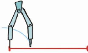
Tomamos la medida del lado de 2 cm con el compás. Pinchamos sobre un extremo del segmento y trazamos un arco.
