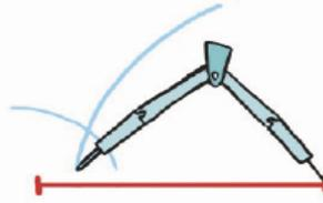
Tomamos la medida del tercer lado con el compás. Pinchamos sobre el otro extremo del segmento y trazamos un arco.
