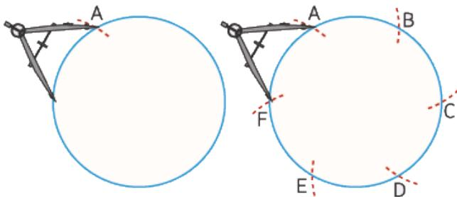
Desde A trazamos un nuevo arco que llamamos B. Sin cambiar la abertura del compás, repetimos el proceso hasta volver al primer arco trazado, A.
