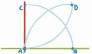
Pinchamos en B y trazamos un arco. Pinchamos en C y trazamos otro arco. El punto de corte de los arcos es el vértice D.
