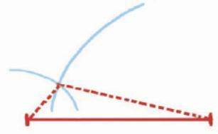
Unimos el punto en el que se cortan los arcos con los extremos del segmento.
